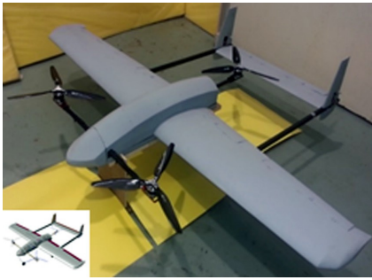
चित्र 8: 7 किलो VTOL UAV का अभिकल्प और विकास और 1 किलो VTOL UAV का उड़ान परीक्षण।
