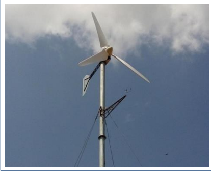
चित्र 15 : 4 kW NALWIN पवन टरबाइन
