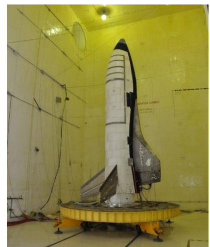
चित्र-11: अनुरणन चैंबर में RLV-TD उड़ान यान
