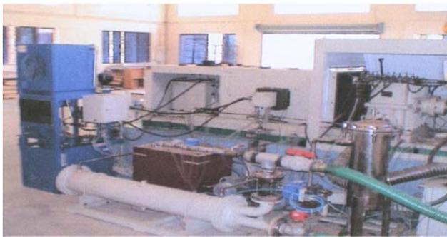
Fig. 17. Rolling element bearing test rig.
